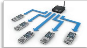
Stellen Sie automatische Firmware-Updates für Diktiergeräte der Pocket Memo-Serie bereit. Die Firmware wird automatisch aktualisiert, wenn Sie das Diktiergerät an den WLAN-Adapter anschließen.
